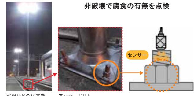
非破壊で腐食の有無を点検
