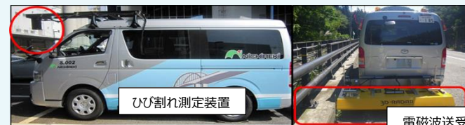
床版かぶり厚の推定が可能なレーダー探査車
