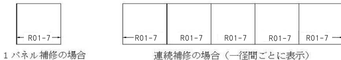
図-2.4.2 施工年月（和暦）・施工範囲の明示箇所 （図の年月及び矢印は、例）
