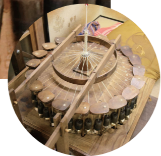
「内記台」で帯締めを組み上げていく。手動で歯車を動かすと20枚の葉っぱ型の板が180度回転しながら絹糸を引っかけて移動し、組紐が組まれていくしくみ。回転のたびにガチャガチャと音がするので、「ガチャ台」とも呼ばれる。玉（絹糸）の並べ方と上部の輪の上げ下ろしで、さまざまな柄をつくりだすことができる。「たとえば白黒の順で玉を並べると横の柄に。白2本黒2本と並べると縦の柄に。3本1本と並べると亀甲柄になります」と太田さん。
