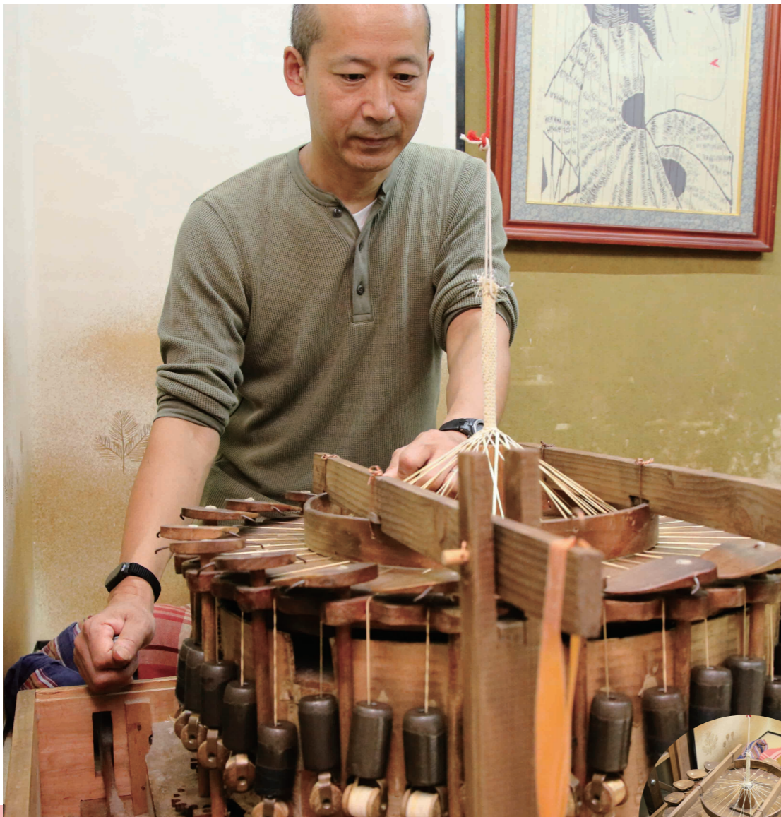
「内記台」で帯締めを組み上げていく。手動で歯車を動かすと20枚の葉っぱ型の板が180度回転しながら絹糸を引っかけて移動し、組紐が組まれていくしくみ。回転のたびにガチャガチャと音がするので、「ガチャ台」とも呼ばれる。玉（絹糸）の並べ方と上部の輪の上げ下ろしで、さまざまな柄をつくりだすことができる。「たとえば白黒の順で玉を並べると横の柄に。白2本黒2本と並べると縦の柄に。3本1本と並べると亀甲柄になります」と太田さん。
