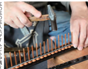
五の玉の玉入れが済んだら中棧にはめひごをコンコンと打ち込んで組み立てていく。この後、一の玉の玉入れをして、枠をはめた後もさらに作業は続く。
