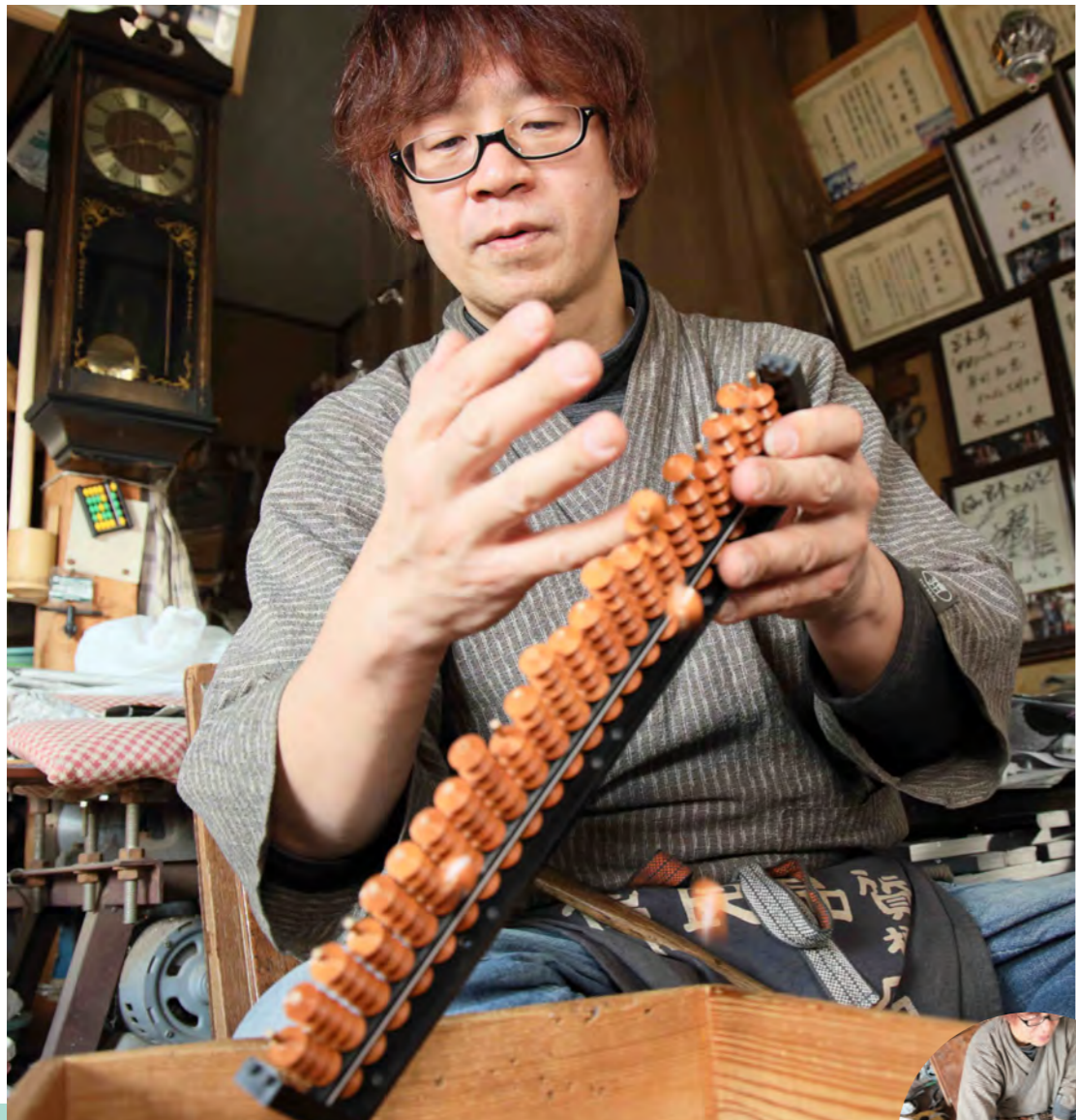
玉が入った箱のなかで、ザーザーと音を立てるように枠を動かすと見事に4玉以上の玉が入る「玉入れ」。指ですすくと余分な玉をはじくと、きれいに4玉ずつ揃う。高山さんは播州そろばんを紹介する工芸展などのイベントにしばしば出席する。その際、ユーザーに玉入れを体験してもらうことがあるが、「これまで何百人に体験してもらって4玉以上揃っていった方はいないです」。それでも、職人にとって玉入れは簡単な部類の工程。
