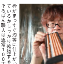
いちばん神経を使うのは「玉の動きの調整」だと高山さん。ひごを磨きながら、あるいは組み上がったからも、玉の動きを随時調整する。玉仕上げが済んだ玉の穴を、微妙に削って修正することもある。
