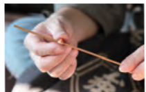
いちばん神経を使うのは「玉の動きの調整」だと高山さん。ひごを磨きながら、あるいは組み上がったからも、玉の動きを随時調整する。玉仕上げが済んだ玉の穴を、微妙に削って修正することもある。
