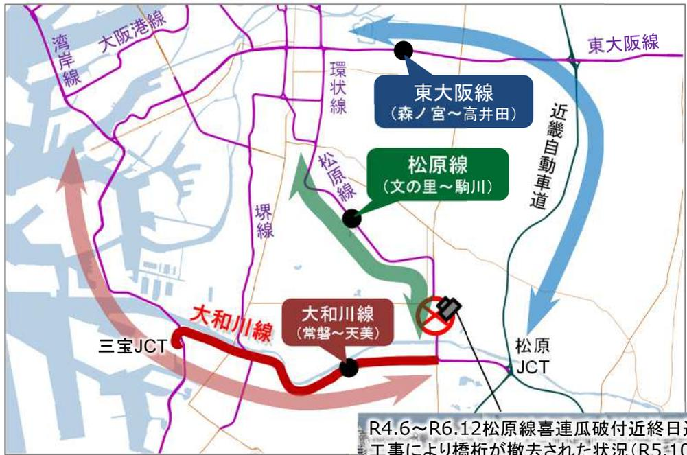
松原線喜連瓜破付近の橋梁は、供用から約40年を経過しており、経年とともに設計時の想定を上回る垂れ下がりが進行。そこで、長期の健全性・耐久性を確保するため、架替え工事を実施。→架替え工事にあたり、大和川線を活用した迂回誘導を実施
