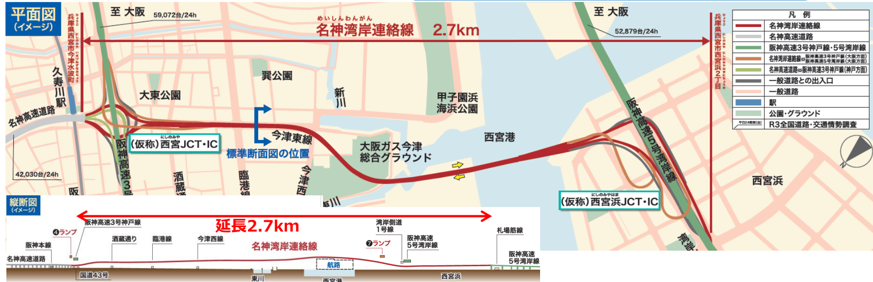
注)この縦断図は名神高速道路→名神湾岸連絡線→阪神高速5号湾岸線(神戸方面)のランプをイラスト化したものです。イメージであり、構造等は確定したものではありません。
