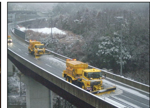
湿塩散布車による除雪作業
