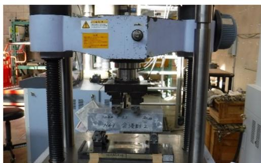
写真-3 ひび割れ導入状況
