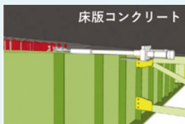
WJによる接合部の除去
