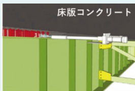
WJによる接合部の除去
