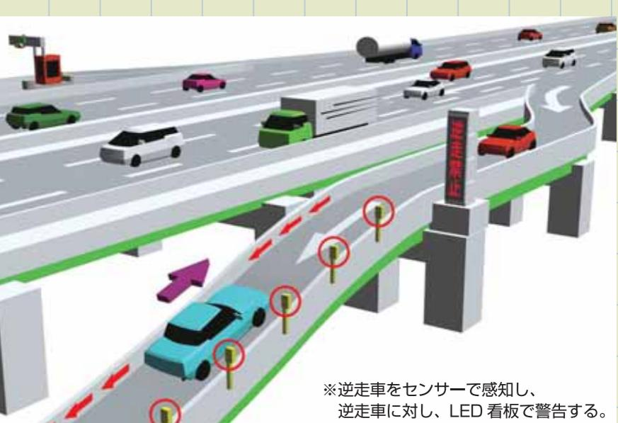
※逆走車をセンサーで感知し、逆走車に対し、LED看板で警告する。
