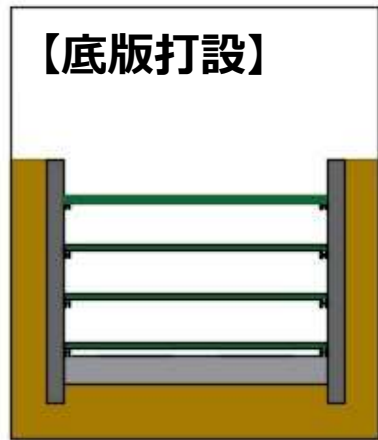
(5) 本体工の底版を打設する。
