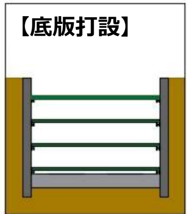
(5) 本体工の底版 を打設する。
