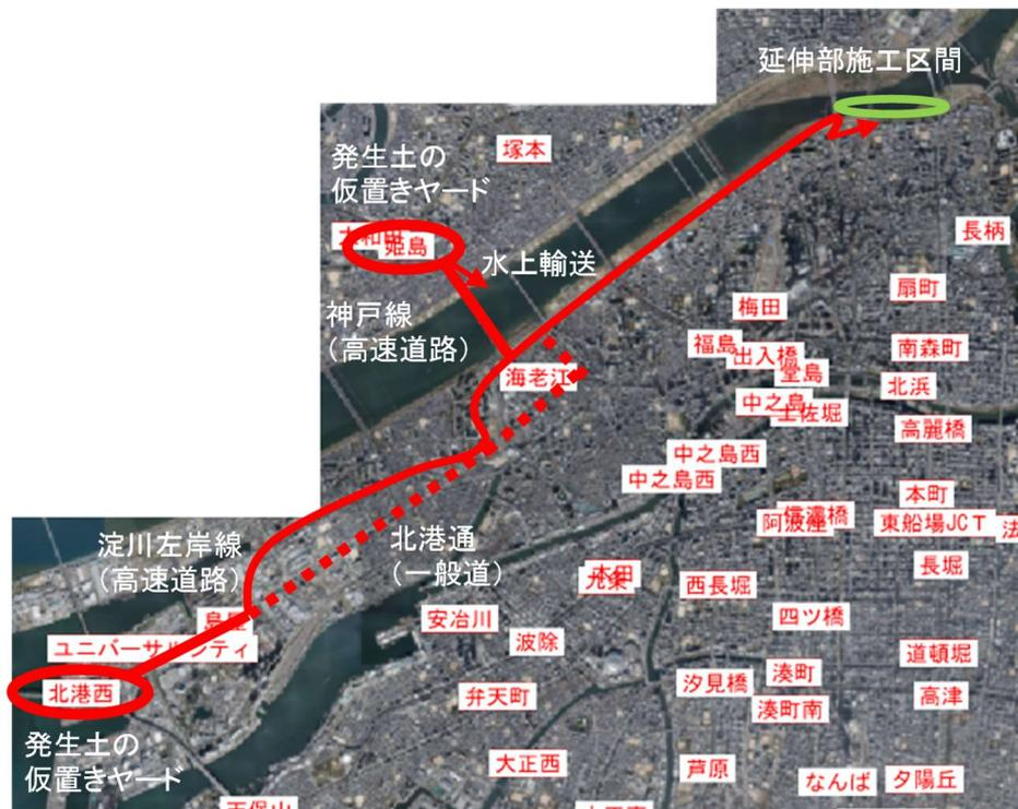
図 3.3.2-6 復旧土の運搬計画の概要
