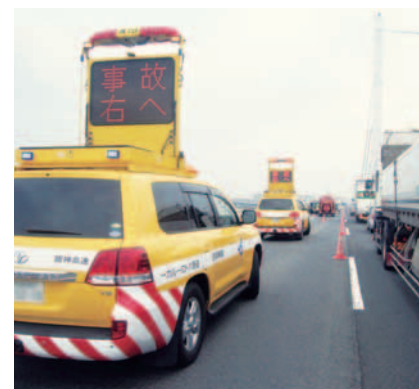
事故発生のため車線規制を行い、後方警戒にあたるパトロールカー。
