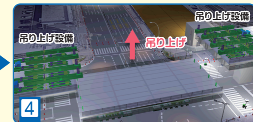
南北の新設橋桁に取り付ける吊り上げ設備を用いて中央の新設橋桁を吊り上げます
